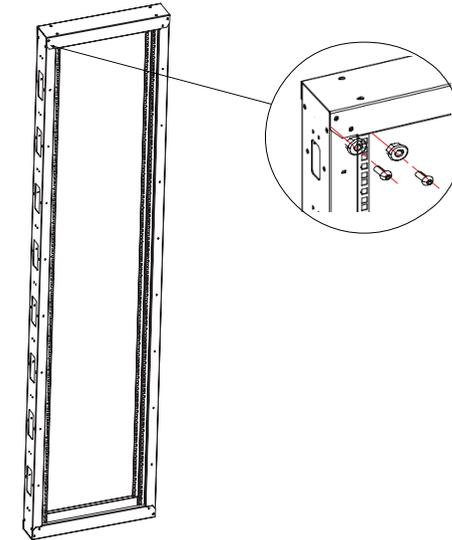
Step 1: Montieren Sie die Ständer und die Querstreben mit 16 Sätzen M6\*12 Schrauben und M6 Muttern, um den Rahmen zusammen zu bauen.
