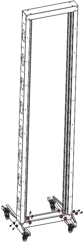
Step 3: Verschrauben Sie Rahmen und Sockel mit 8 Sätzen M6\*12 Schrauben und M6 Muttern.
