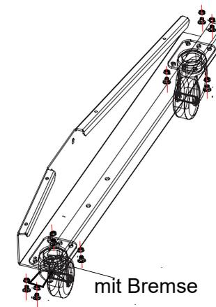
Step 2: Montieren Sie die Rollen auf den Sockeln mit 16 Sätzen M6\*12 Schrauben und M6 Muttern.
