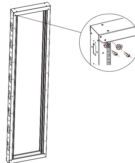
Step 1: Montieren Sie die Ständer und die Querstreben mit 32 Sätzen M6\*12 Schrauben und M6 Muttern, um den Rahmen zusammen zu bauen.
