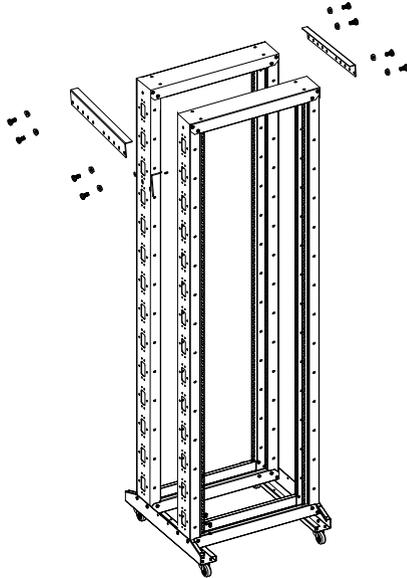
Step 4: Montieren Sie die Dachstreben mit 8 Sätzen M6\*12 Schrauben und M6 Muttern an die Rahmen.
