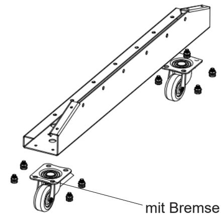
Step 2: Montieren Sie die Rollen auf den Sockeln mit 16 Sätzen M6\*12 Schrauben und M6 Muttern.
