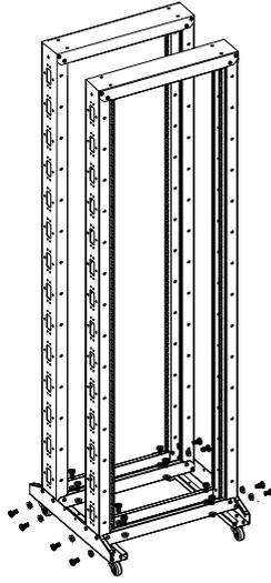
Step 3: Verschrauben Sie Rahmen und Sockel mit 16 Sätzen M6\*12 Schrauben und M6 Muttern.
