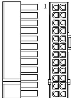
Die Pins 11/ 12/ 23/ 24 sind als separater Stecker ausgebildet. Dieser kann zur Kompatibilität älterer Mainboards abgeklappt werden.
