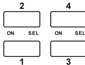
Die Bedienelemente an der Front der Geräte sind sowohl Auswahlknöpfe als auch LED Statusanzeigen.
