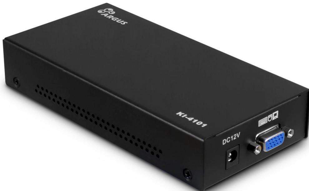
Das **KVM KI-4101** ist ein KVM over IP-Modul sowie eine Erweiterung für die KVM-Switche der Typen AS-9108DU, KS-3104 und KS-3108 und der LCD KVM Konsolen der Typen AS-71xx ULS, AS-71xx TLS, AS-91xx ULS und AS-91xx TLS. Mit dem Modul können die angeschlossenen Geräte und KVM-Switche über das Netzwerk ferngesteuert werden.
