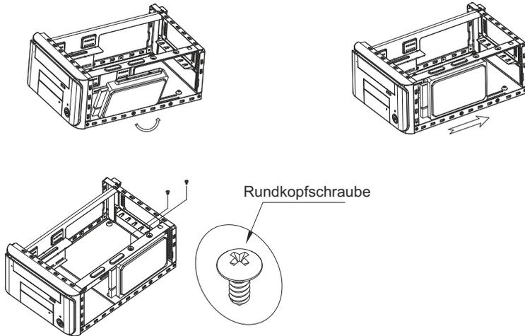
6. Setzen Sie die 2,5" Festplatte von unten gegen das Blech und befestigen Sie sie von oben mit den Rundkopfschrauben.
