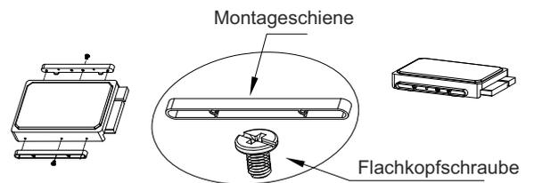
5. Setzen Sie die Festplatte wie auf dem Bild gezeigt in das Gehäuse ein und schieben Sie sie nach vorne. Befestigen Sie sie mit den beiliegenden Rundkopfschrauben.
