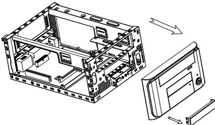
3. Schieben Sie die Geräte von vorne in die entsprechenden Schächte und richten Sie sie so aus, dass sie den richtigen Abstand zur Frontblende haben. Befestigen Sie sie mit Schrauben
