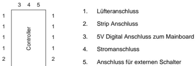
Haben Sie alle Lüfter angeschlossen, verbinden Sie den Controller mit einem Molex-Anschluss Ihres Netztesiles.
