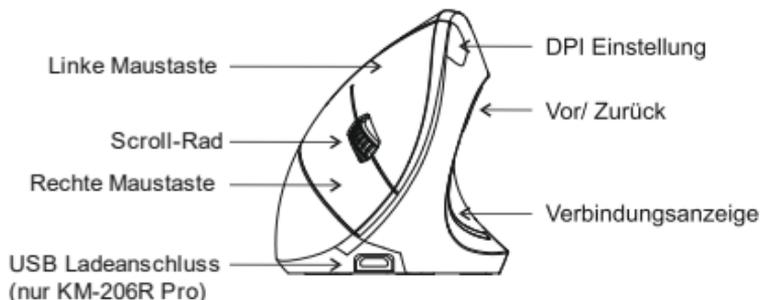
Bei dem Modell KM-206L sind die Tasten entsprechend spiegelverkehrt angeordnet.
